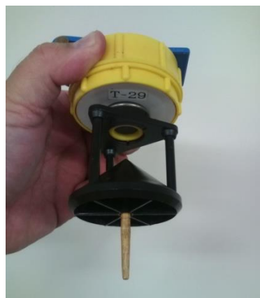
スプレッダーの穴に棒を差し込んで、測量ポールの上部の穴に通す。
