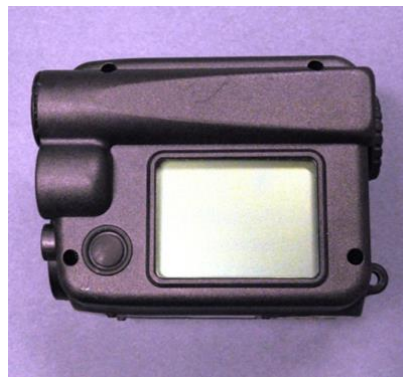
レーザー測高器 2 : バーテックスレーザー (音波計測機能も併せ持つ)
